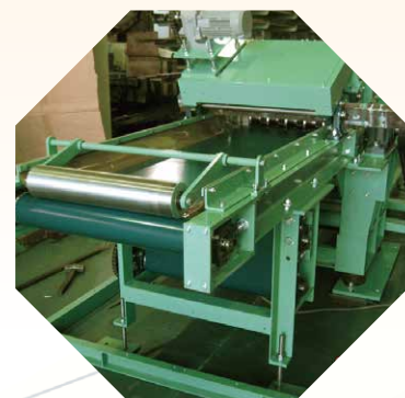
搬送コンベヤ
